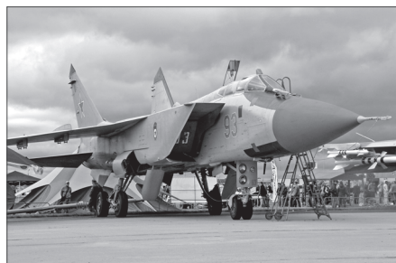
Die fast dreifache Schallgeschwindigkeit schnelle MiG-31K dient als Plattform für die Kh-47M2 "Kinzhal". Foto: BS/Dmitry Terekhov, CC BY-SA 2.0, abstrix.com
